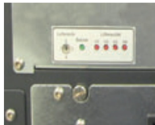
Индикатор отказа вентилятора / четыре уровня оборотов
