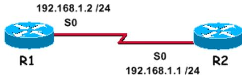
Если в сети работает протокол EIGRP, команда `passive-interface` блокирует исходящие и входящие обновления маршрутизации, поскольку результат команды приводит к остановке маршрутизатором отправки и приема hello-пакетов по интерфейсу.
