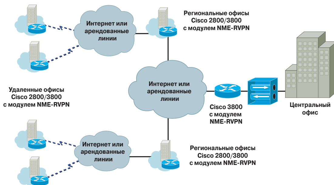
Рисунок 2. Использование VPN-туннелей для создания защищенной корпоративной сети
