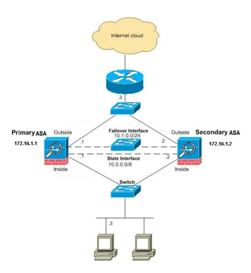
Данный раздел посвящен настройке аварийного перехода с активного на резервный ресурс в прозрачном режиме с использованием Ethernet-соединения в качестве соединения аварийного переключения. При настройке аварийного переключения с использованием локальной сети необходимо выполнить начальную загрузку вспомогательного модуля, чтобы распознать канал переключения до того, как вторичный модуль сможет получить текущую конфигурацию от основного устройства.
